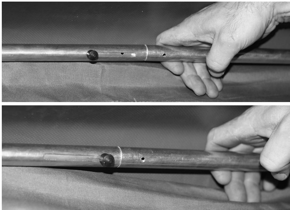
Рис 12.Закрепление замка привальников.
