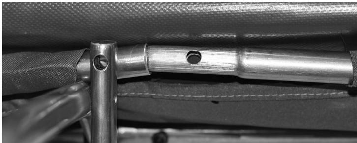
Рис 14.Соединение фальшбортов.
