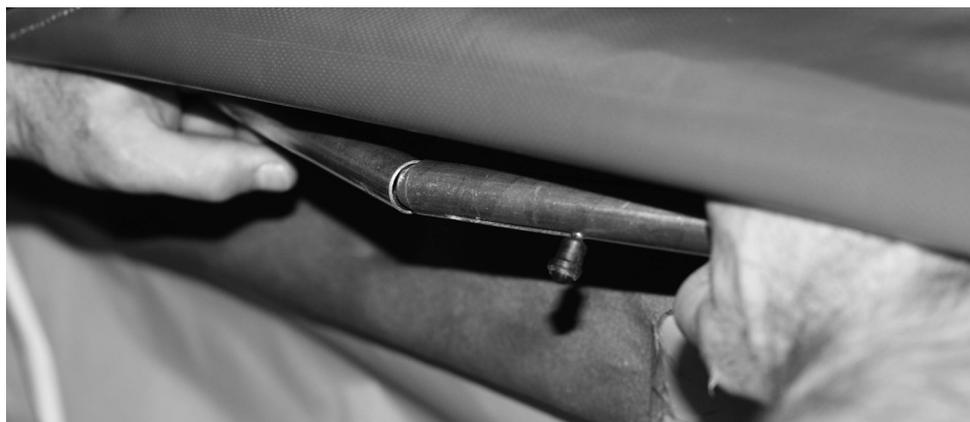
Рис 11. Соединение привальников
