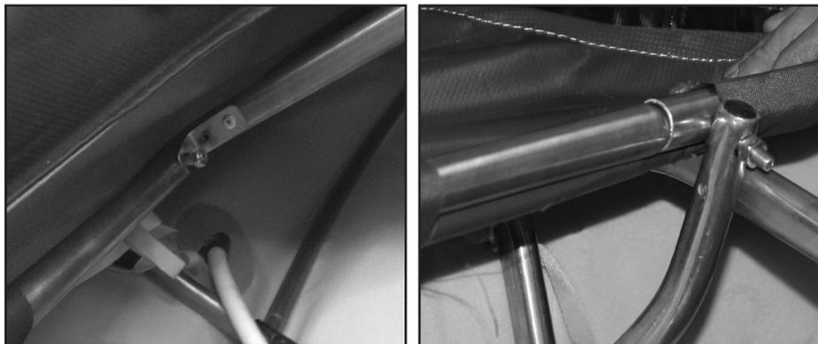
Рис. 15. Установка фальшбортов.
