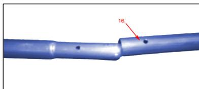
Рис 2. Соединение привальников
