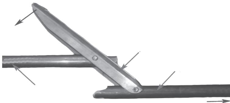
Рис 8. Замок кильсона
